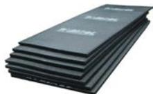
Pannello acustico in polietilene espanso fisicamente non reticolato a celle completamente chiuse, materiale eco-compatibile, riciclabile al 100%, tipo PANISOL P40, spessore nominale 40mm, densità 25 Kg/mc rivestito sulla faccia a vista con una speciale pellicola antilacerazione gofrata. Il Pannello acustico avrà altezza di mm 2.950 e larghezza mm 1.200 e una conducibilità termica di 0,040 W/mk
