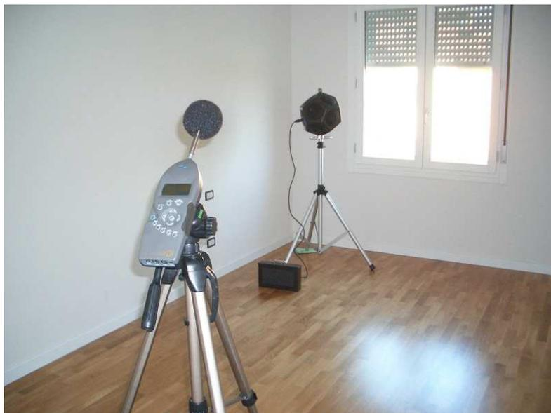
*Foto della strumentazione posizionata nell'ambiente emittente*
